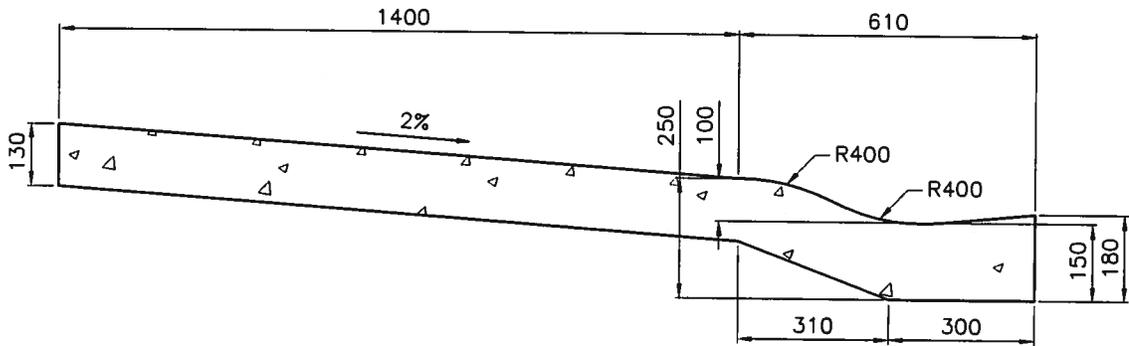
COMBINED SIDEWALK ROLLED CURB AND GUTTER
